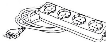
Spine di tipo tedesco (Schuko) possono essere inserite in prese di tipo italiano solo tramite un adattatore che trasferisce il collegamento di terra effettuato mediante le lamine laterali ad uno spinotto centrale. E' assolutamente vietato l'inserimento a forza delle spine Schuko nelle prese di tipo italiano. Infatti, in tale caso dal collegamento verrebbe esclusa la messa a terra.
