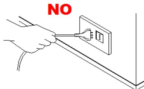
Non attaccare più di un apparecchio elettrico a una sola presa. In questo modo si evita che la presa si surriscaldi con pericolo di corto circuito e incendio.
